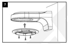
Bei Wandarm: befestigen Sie die Bodenplatte am Wandarm.
