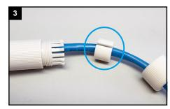
In der Dichtung ist ein seitlicher Schlitz. Führen Sie die Dichtung mit diesem Schlitz um das Kabel herum.
