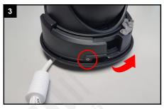
Lockern Sie die Schraube, bis sich die untere Bodenplatte in Pfeilrichtung drehen lässt.
