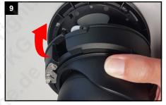
Dichten Sie die übrigen Kabelverbindungen gegen Feuchtigkeit und verstauen Sie diese zwischen Bodenplatte und Kamera.
