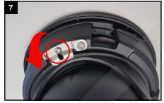
Setzen Sie die Kamera wieder ein, richten Sie die die Blickrichtung aus, klappen Sie den Bügel wieder ein und ziehen Sie die die Schraube fest.
