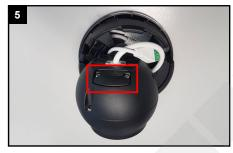
Unter der Abdeckung befinden sich der Kartenslot und die Reset-Taste.
