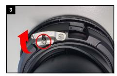
Halten Sie die Kamera fest, damit sie nicht herunterfällt. Lösen Sie dabei die Schraube und klappen den Bügel aus.
