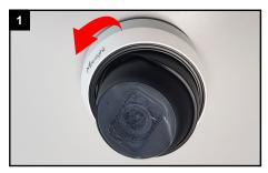
Drehen Sie die weiße Abdeckung in Pfeilrichtung, um sie zu lösen und nehmen Sie die Abdeckung
