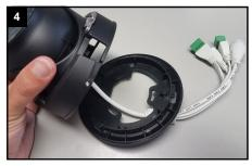
Nachdem Sie die Bodenplatte durch einer Drehung gelöst haben, nehmen Sie diese ab.
