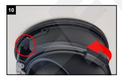
Drehen Sie die Kamera in Pfeilrichtung, bis sie wieder in die Bodenplatte einrastet.
