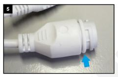
Ziehen Sie den Dichtungsring auf die Buchse am Anschlusskabel der Kamera.
