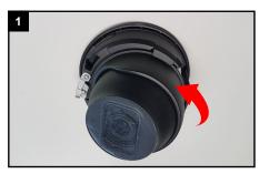
Der Kartenslot und die Reset-Taste befinden sich hinter der Abdeckung auf der Rückseite des Kamera-Kugelkopfs.
